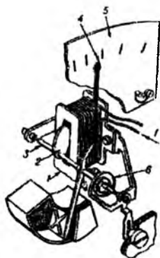
5-7-rasm. Elektromagnit asboblarning asosiy elementlari: 1 – g'altak; 2 – o'zak; 3 – o'q; 4 – strelka; 5 – shkala; 6 – prujina.
