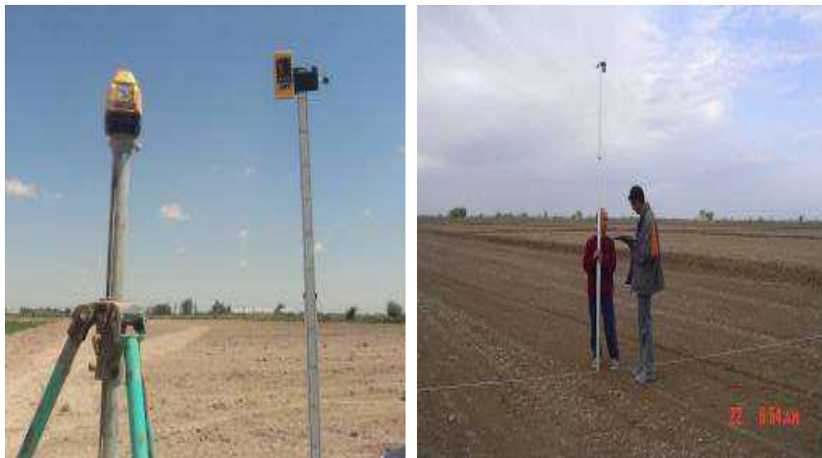
12-rasm. Lazer uzatkich transmitter va o'lchov lineykasida o'rnatilgan lazer qabul qilgich transmitterdan uzatilgan ma'lumotni qo'l lazer qabul qilgichdagi tovushli signalga qarab operator dalaning o'lchov nuqtasini belgilab oladi.
