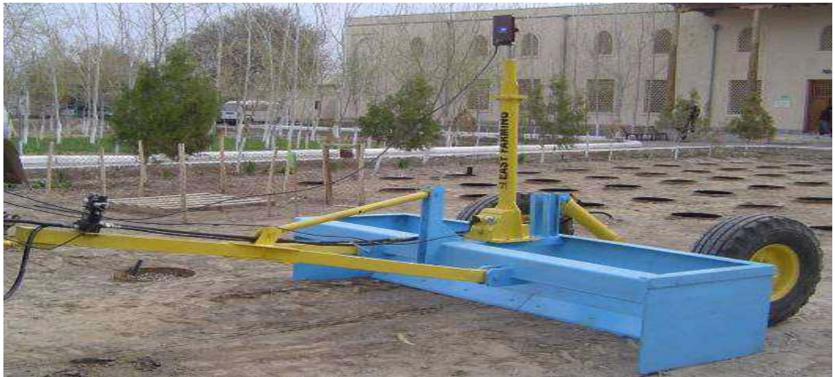
11 - rasm. Lazer tekislagichning asosiy qismlari: 1 – tirkama rama; 2 – kovsha; 3 – lazer nurini qabul qilgich resiver uchun machta; 4 – gidrotsilindr va shlanglar; 5 – g‘ildirak va g‘ildirakli rama.
