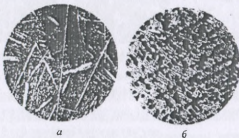
12.1-rasm. Qayta ishlanuvchi oq cho'yan mikrostrukturasi (x200). a) – evtektikadan keyingi oq cho'yan ( S=5,5\% ); b) – evtektikagachadagi oq cho'yan ( S=2,5\% ). Rasmdagi qora ranglilari bu perlit; oq ranglilari ledeburit.
