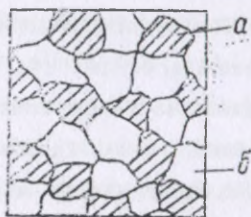
5.4-rasm. Mexanik aralashmaning mikroskopik tuzilishi. (sxemasi)
