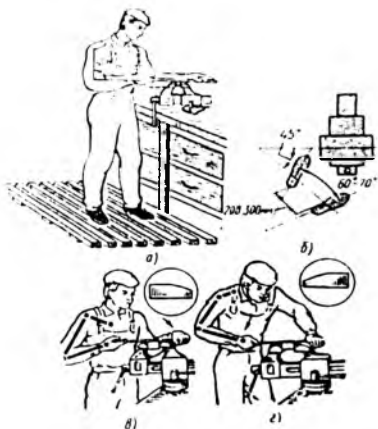
50- расм. Эговлашда иш вазияти: а—ғавданинг вазияти, б—осқларнинг вазияти, в— эговга сал-пал босиш, г—эговга қучли
