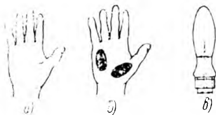
3- расм. Асбоб дасталарининг рационал шакллари танлаш: а—кафтнинг энг бўш қисмлари; б—кафтнинг энг кучли ва эластик мускуллари; в— дастанинг рационал шакли
