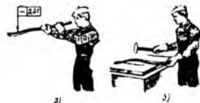
141-расм. Текислиги бўйича эгилган полоса металлни тўғрилаш:
