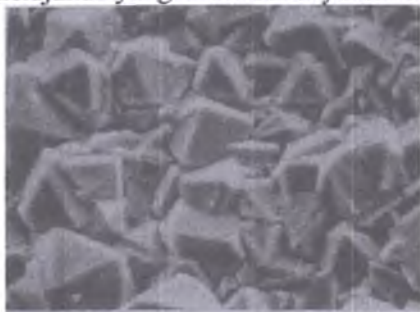
4.3-rasm Olmos plyonkasi sirtining skaner qiluvchi elektron mikrofotoografiya.
