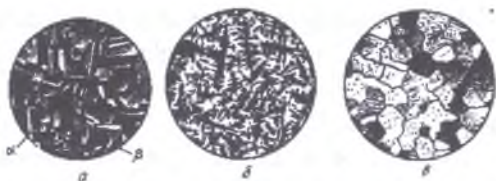
3.9-rasm. Mis qotishmalarining mikrostrukturalari. A- yumshatilgan lotun. B-quyma bronza. V- yumshatilgan bronza.
