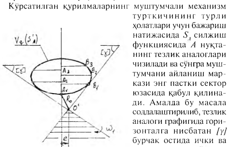
5.33-шакл. Муштумчани минимал радиуси ва дезаксиаллик масофасини аниқлаш.
