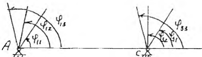
4.67-шакл. Айлангич-чайқалгичли механизмнинг уч ҳолатига қараб синтези.
