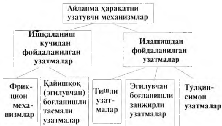
6.1-шакл. Ҳаракатни узатувчи механизмларнинг классификацияси.
