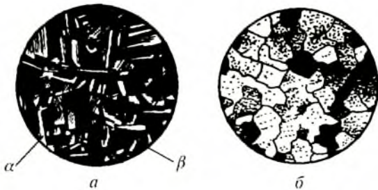
58-расм. Юмшатирилган латунь (а) ва бронза (б)ларнинг микроструктураси.
