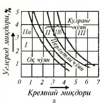
11-расм, а ва в. Углерод, кремний ва девор қалинлигининг чўян турига таъсир этиш графиги
