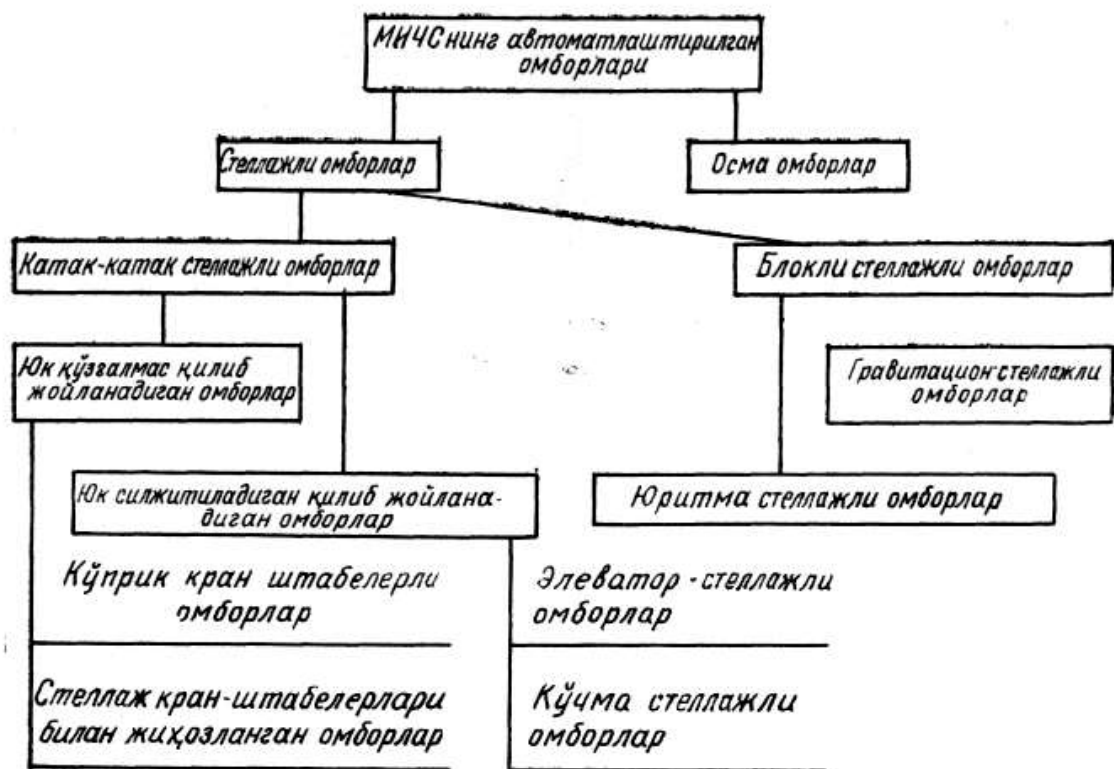
145-расм. МИЧТнинг автоматик ишлаб чиқариш омборлари классификацияси
