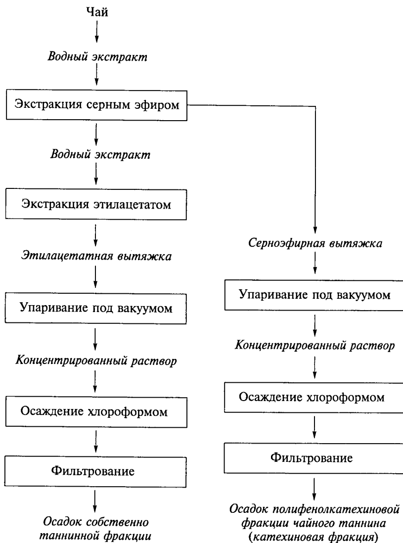
Рис. 24. Схема разделения чайного таннина на таннинную и катехиновую фракции
