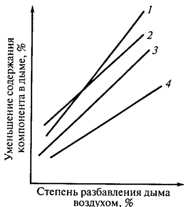
Рис. 21. Влияние степени разбавления дыма на концентрацию его компонентов:
