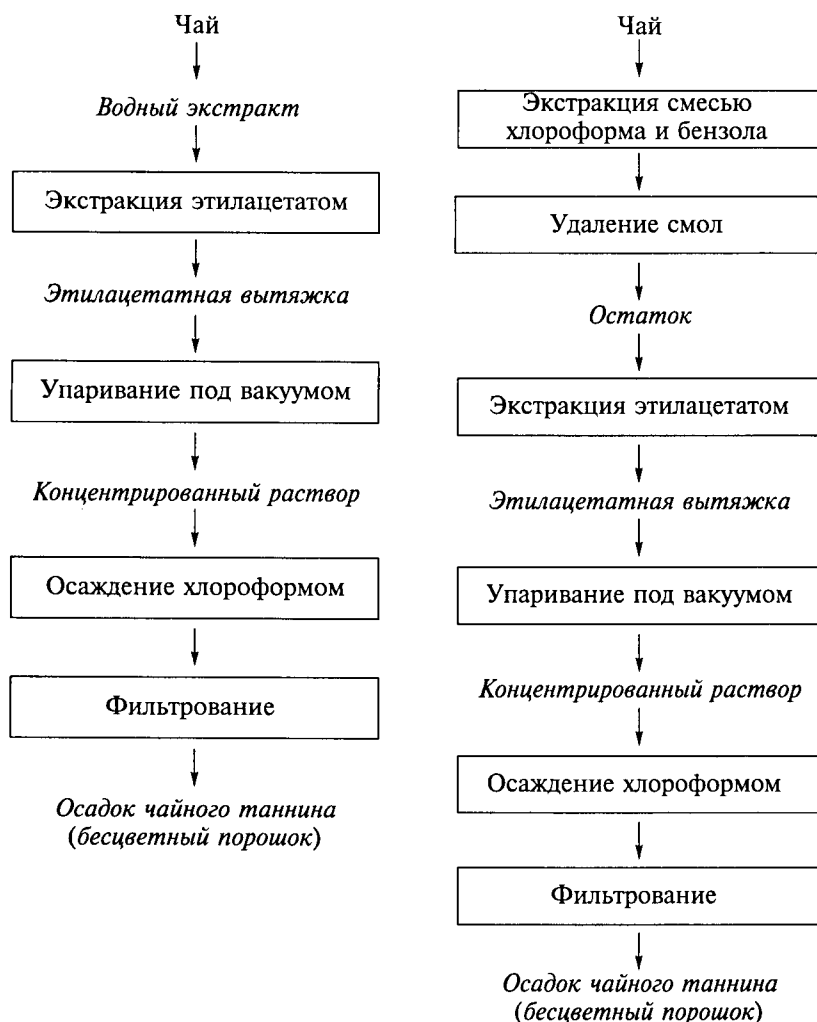
Рис. 23. Схема выделения чайного таннина
