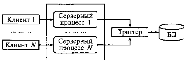
Рис. 10.7. Взаимодействие клиентских и серверных процессов в модели «один к одному»
