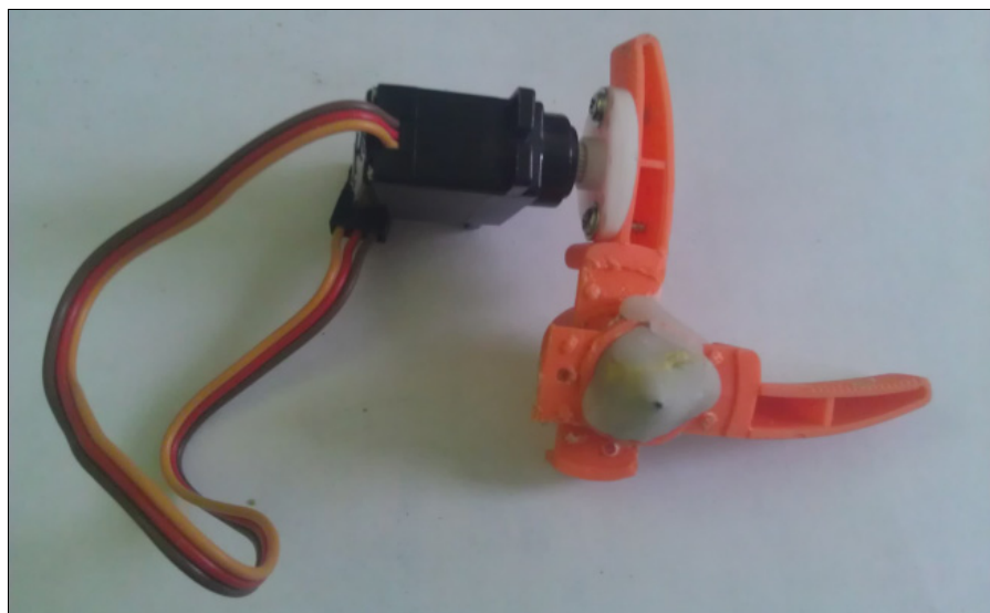
Рис. 23.5. Ноги робота — крепление к сервомашинке
