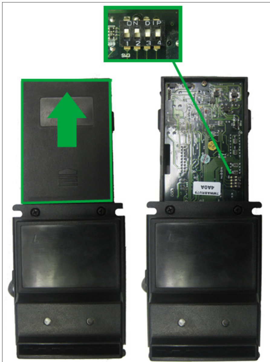
Рис. 17.3. Третий блок переключателей купюроприемника ICT V7
