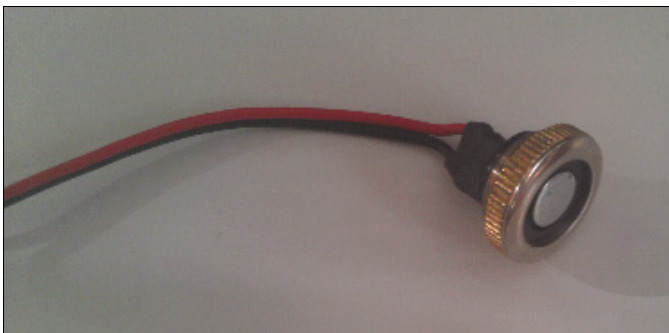
Рис. 11.5. Контактная площадка для устройств iButton
