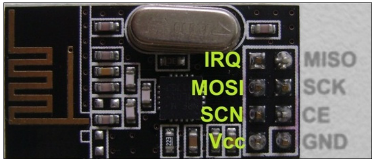
Рис. 27.3. Назначение выводов модуля NRF24L01
