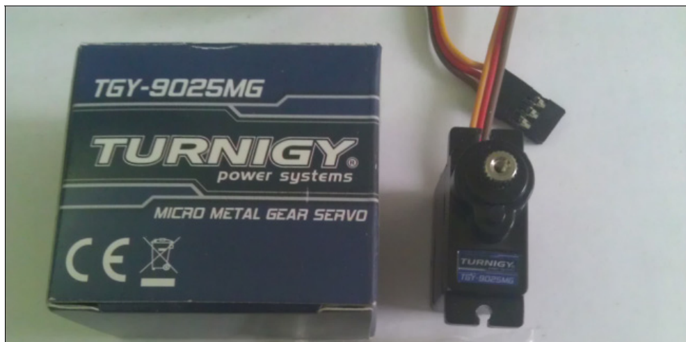
Рис. 23.3. Сервопривод Turnigy TGY-9025MG
