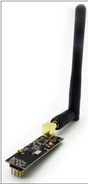
Рис. 27.2. Модуль NRF24L01 с антенной
