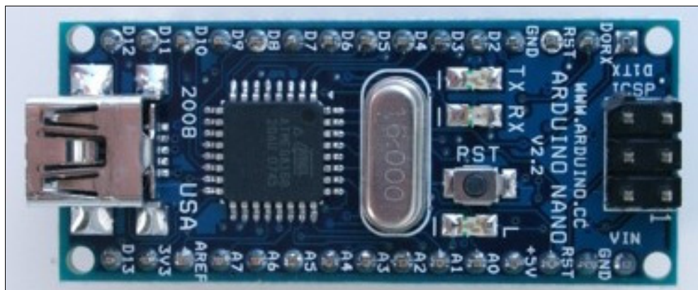
Рис. 2.3. Плата Arduino Nano
