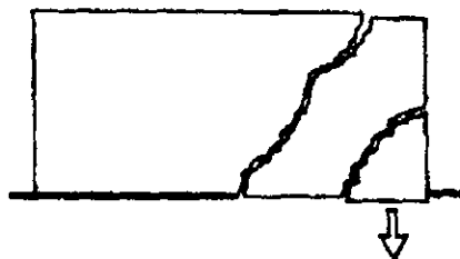
3.7.1-rasm. Binoning chekka yoki burchak qismi cho'kishi.
