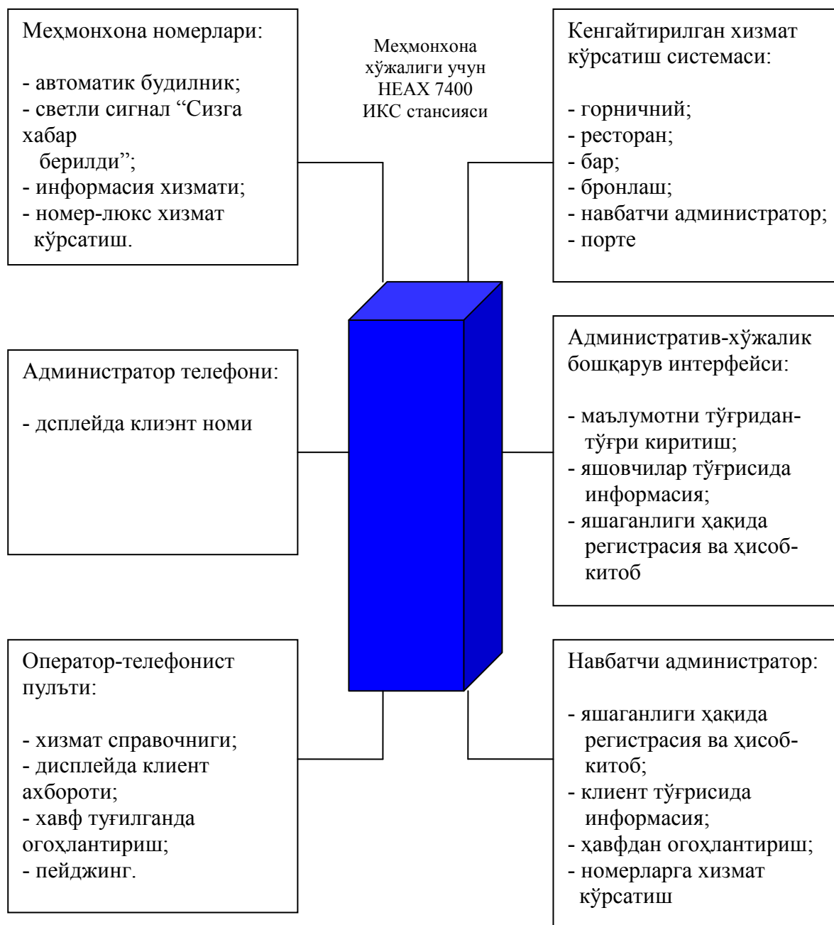
Расм-6.11. Миллиэниум NEAX 7400 ИКС мисолида меҳмонхона учун станция схемаси.
