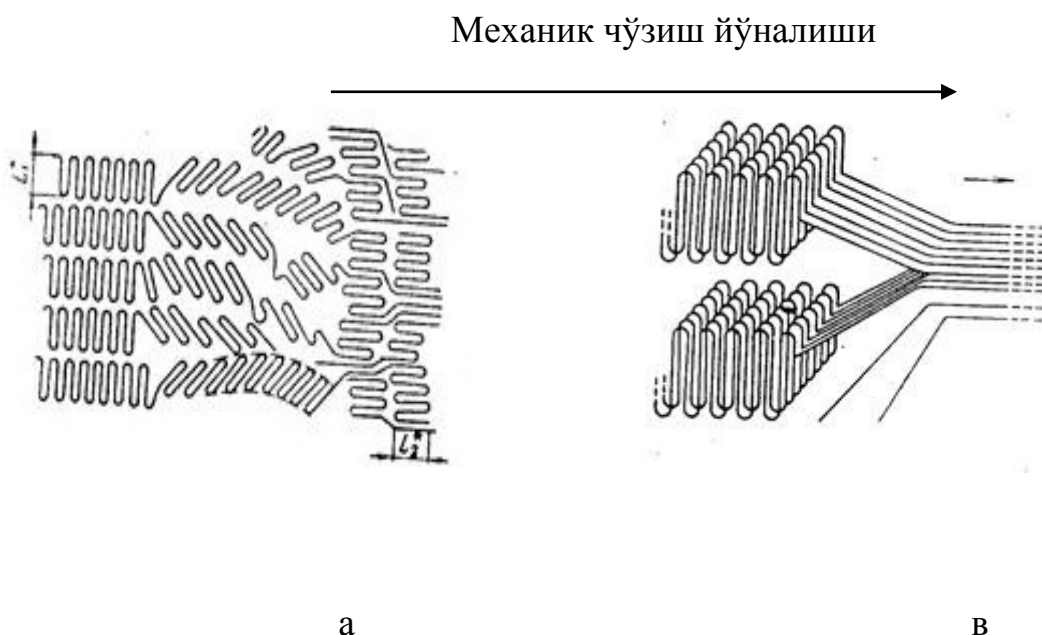
3-расм. Пленка механик чўзишда ламелляр қатламларни йўналишини ўзгартириб ориентирланиши (а) ва парчаланиб ориентацион ҳолатга (в) ўтиши
