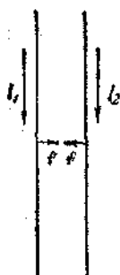
174- расм. Параллел жойлашган иккита ўт- казгичдан бир томонга йўналган электр токи ўтганда бу ўтказгич- ларнинг ўз- аро тортиши- ши.
