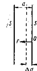
59- расм. Конденсатор пластинкаларига таъсир этувчи кучларни ҳисоблашга доир.
