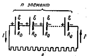
116- расм. Элементларни кетма-кет улаб батарея ҳосил қилиш.
