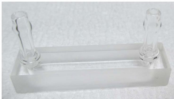
Рис. 2.2.2. Общий вид кюветы для комбинационного рассеяния света.
