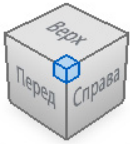
Рис. 10.17. Установка вида по вершине куба
