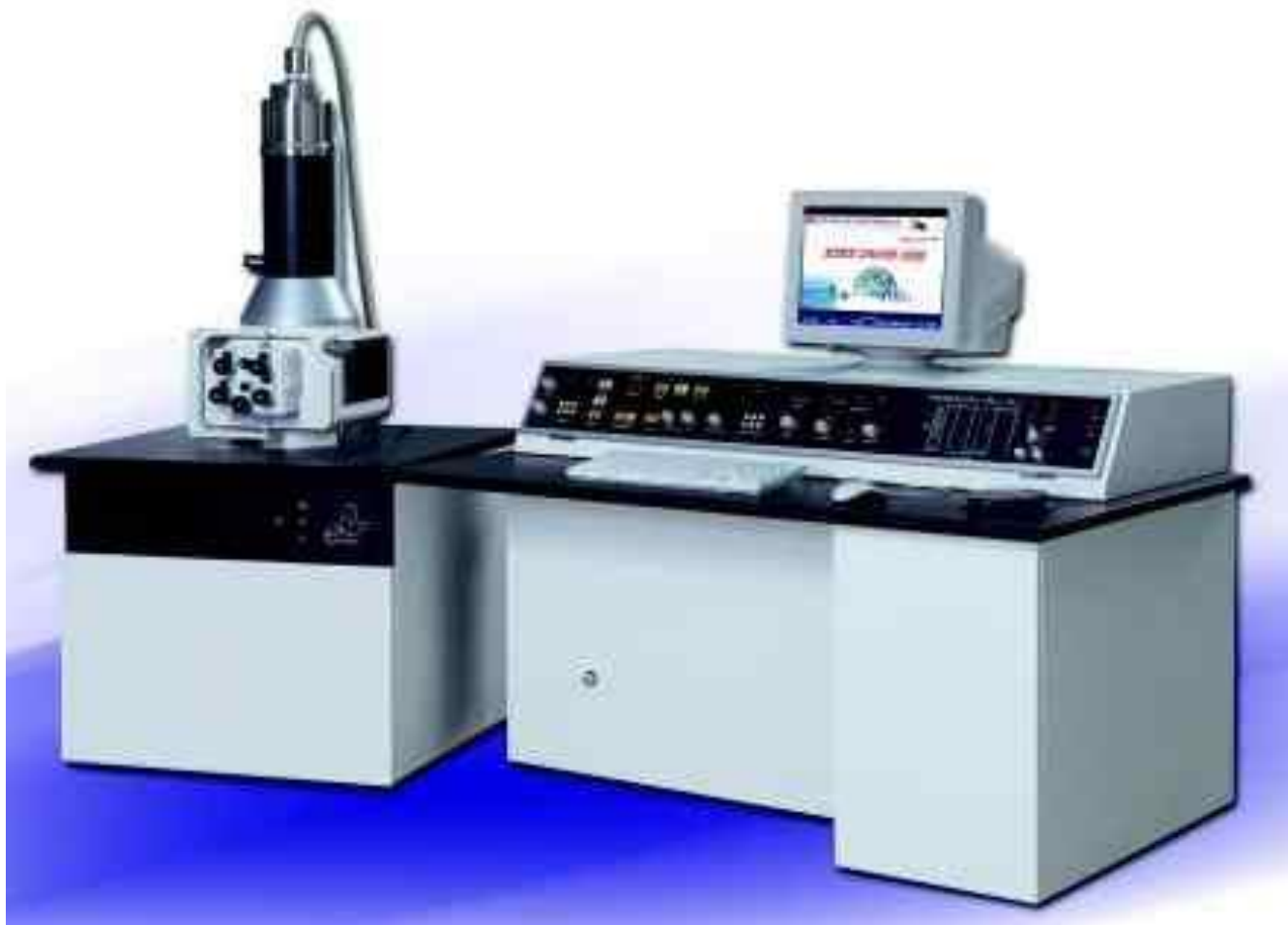
Skanerlovchi elektron mikroskop, model: COXEM, Janubiy Kareya.
