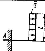
**2.3.24.** Qistirib mahkamlangan ramaning qancha qismiga intensivligi  $q_{\max}=1\text{N/m}$  bo'lgan taqsimlangan kuchlar ta'sir etsa,  $A$  tayanchning reaksiya kuchi  $R_A=2\text{N}$  bo'ladi? (4,0)
