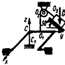
5.7.7. Og'ir yuk sim arqon vositasida richagli valga osib qo'yilgan. Richagli val esa podshipniklari va  $CC_1$  sim arqon yordamida mahkamlangan. Agar  $\alpha=30^\circ$  va  $CC_1$  vertikal sim arqonning tarangligi  $20\text{kN}$  bo'lса,  $AC=BC$  deb olib, yukning og'irligini toping ( $\text{kN}$ ). Bunda  $ABDE$  tekislik gorizontal,  $DO_1O_2$  esa vertikal deb oling. (20)
