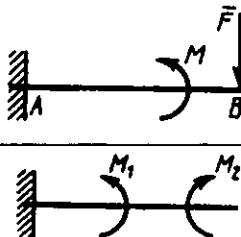
**2.4.33.** Qistirib mahkamlangan to'singa momentlari  $M_1=1790\text{N}\cdot\text{m}$  va  $M_2=2135\text{N}\cdot\text{m}$  bo'lgan juft kuchlar ta'sir etayotgan bo'lsa, tayanchdagi reaktiv momentni aniqlang. (-345)
