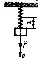
**13.6.5.** Massasi  $m=3\text{kg}$  bo'lgan, yuk prujinaga osilgan. Unga  $F=10\sin 5t$  vertikal uyg'otuvchi kuch ta'sir etadi. Agar dinamiklik koefitsiyenti  $\eta=4$  bo'lsa, prujinaning bikrlik koefitsiyenti  $c$  ni aniqlang. (100)
