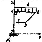
**5.4.6.** O'lchainlari  $AB=3\text{m}$ ,  $AB \parallel Ox$ ,  $BD \perp AB$ ,  $BD \parallel Oy$  bo'lgan bukilgan to'singa miqdorlari  $F=10\text{N}$  kuch va intensivligi  $q_{\max}=20\text{N/m}$  li taqsimlangan kuchlar ta'sir etadi. Kuchlar sistemasining bosh vektorining miqdorini aniqlang. (20)
