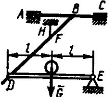
5.7.5. Og'irligi  $4 \text{ kN}$  bo'lgan bir jinsli DE to'sin vertikal tekislikda joylashgan bo'lib, gorizontal holatdagi silliq plastinaga D nuqtada tiralgan. Agar plastina AC o'q va FH sim arqon bilan mahkamlangan bo'lsa, sim arqonning tarangligini kN da toping. Bunda  $FB=2DF$ ,  $AC \perp BD$ ,  $ED \perp DB$ . (3)
