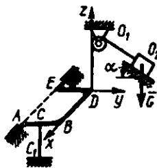
**5.7.8. Og'irligi  $G=2,5 \text{ kN}$  bo'lgan yuk sim arqon yordamida richagli valga osib qo'yilgan.** Richagli val esa podshipniklar va  $O_1O_2O_3$  sim arqon vositasida mahkamlangan. Agar  $ABCD$  gorizontal holatda,  $O_1O_2O_3$  tekislik  $Byz$  tekislikka parallel va  $DO_1=O_1C$  bo'lsa,  $O_2$  sharnirda hosil bo'lgan reaksiya kuchini aniqlang ( $\text{kN}$ ). (17,3)
