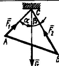
**1.2.4.** Og'ir jism devorga ikkita sterjen yordamida mahkamlangan. Agar sterjenlar  $\beta=60^\circ$ , va o'zaro  $\alpha=15^\circ$  burchak ostida, sterjenlardagi zo'riqishlar  $F_1=17\text{N}$  va  $F_2=45\text{N}$  bo'lsa, jismning og'irligini toping. (10,44)
