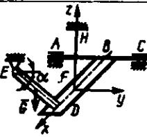
**5.7.6.** Og'irligi  $G=10\text{kN}$  bo'lgan yuk sim arqon vositasida richagli valga osib qo'yilgan. Richagli val esa podshipniklar va  $CC_1$  sim arqon yordamida mahkamlangan. Agar  $Cxy$  tekislik gorizontal,  $O_1O_2O_3$  tekislik esa  $Cyz$  tekislikda joylashgan bo'lsa,  $CC_1$  vertikal sim arqonda hosil bo'layotgan taranglik kuchini toping ( $\text{kN}$ ). (5)
