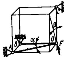
**1.4.10.** Sharnirli konstruksiyaning  $D$  nuqtasiga  $G=200\text{N}$  yuk osilgan. Agar masofalar  $CE=BE=2\text{m}$  va  $AB=BD=4\text{m}$  berilgan bo'lsa,  $CD$  sterjendagi zo'riqishni aniqlang. (-127)
