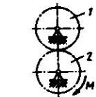
**15.7.5.** Radiusi  $R_2=2R_1$  bo'lgan ikki shkiv tasma yordamida bog'langan bo'lib, tinch holatdan o'zgarmas  $M=2,5\text{N}\cdot\text{m}$  juft kuch momenti ta'sirida harakatga keladi. Agar shkivlarning aylanish o'qiga nisbatan inersiya momentlari  $J_2=2J_1=1\text{kg}\cdot\text{m}^2$  bo'lsa, ikki shkiv uch marotaba aylangandan so'ng burchak tezligi nechaga teng bo'ladi? (11,2)
