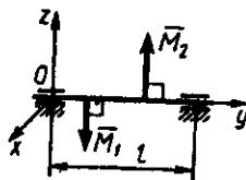
**5.2.16.** Shesternya vali flanesiga (markaziga) momentlari  $M_1=4\text{N}\cdot\text{m}$  va  $M_2=5\text{N}\cdot\text{m}$  bo'lgan juft kuchlar ta'sir etadi. Agar podshipniklar orasi  $\ell=0,1\text{m}$  va  $\bar{M}_1 \parallel Ox$ ,  $\bar{M}_2 \parallel Oz$  bo'lsa,  $O$  podshipnikdagi reaksiya kuchining modulini aniqlang. (64,0)
