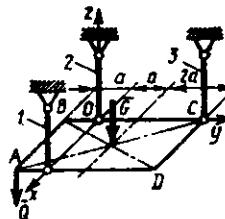
**5.5.9.** Kvadrat shaklidagi  $ABCD$  plitaning og'irligi  $G=115\text{N}$  bo'lib, gorizontal holatda 3 ta vertikal sterjenlar vositasida mahkamlangan. Agar plitaning  $A$  nuqtasiga vertikal  $Q=185\text{N}$  kuch ta'sir qilsa, muvozanat tenglamalarining  $BD$  o'qqa nisbatan olingan momentidan foydalaniib, 2 sterjenning zo'riqishini aniqlang. (-185)
