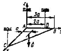
**5.5.11.** Og'irliklari  $G_1=G_3=101\text{N}$  va  $G_2=143\text{N}$  bo'lgan bir jinsli qismidaniborat  $ABC$  uchburchak rama 1, 2 va 3 vertikal po'lat arqonlar yordamida gorizonttal holatda mahkamlangan. 3 arqondagi zo'riqishni aniqlang. (122)
