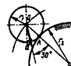
17.2.20. Krivoship 1  $\omega = 4 \text{ rad/s}$  o'zgarmas burchak tezlik bilan aylanib, massasi  $m=4\text{kg}$  va radiusi  $r=15\text{sm}$  bo'lgan bir jinsli 2 g'ildirakni harakatga keltiradi. Agar g'ildirak radiusi  $R=40\text{sm}$  li silindrning ichki devori bo'ylab dumalasa, g'ildirak inersiya kuchlari bosh vektorining modulini aniqlang. (16)
