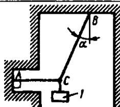
**1.2.7.** Og'ir yuk vaznsiz ikki sterjen yordamida yerga mahkamlangan. Agar  $AC$  sterjen yerga nisbatan  $\alpha=60^\circ$ ,  $BC$  esa  $\beta=30^\circ$  burchak tashkil qilib,  $AC$  sterjenning zo'riqishi  $43\text{N}$  bo'lsa,  $BC$  sterjendagi reaksiya kuchini aniqlang. (-24,8)
