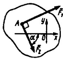
**1.1.8.** Pressning  $O$  nuqtasiga kattaliklari  $F_1=5\text{N}$  va  $F_2=7\text{N}$  ikki kuch ta'sir qiladi. Agar ular bir tekislikda joylashgan va vertikal bilan  $\alpha=30^\circ$  va  $\beta=45^\circ$  burchak tashkil etsa, jismni siquvchi kuchning vertikal tashkil etuvchisining qiymatini aniqlang. (9,28)
