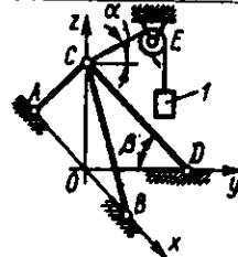
**1.4.3.** Uchta sterjen  $AC$ ,  $BC$  va  $DC$  sharnirlar yordamida mahkamlangan bo'lib,  $C$  sharnirda ularga  $Oyz$  tekisligida joylashgan  $F$  kuchi ta'sir qiladi. Agar  $F=50\text{N}$  va  $\alpha=60^\circ$  berilgan bo'lsa,  $DC$  sterjening zo'riqishini aniqlang. (-86,6)
