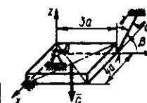
**5.6.11.** Tomonlari  $a=0,2\text{m}$  bo'lgan jism  $G=11\text{kN}$  og'irlikka ega bo'lib,  $F=3\text{kN}$  kuch ta'sirida va shaklda ko'rsatilgan bog'lanishlar yordamida muvozanatda ushlab turiladi.  $AB$  arqonning taranglik kuchini,  $Ox$  o'qiga nisbatan moment tenglamasini tuzib toping. ( $4 \cdot 10^3$ )
