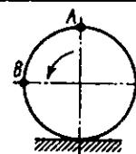
**9.6.3.** Tekislik bo'ylab sirpanmasdan dumalayotgan pog'onali g'ildirakning radiuslari  $r_1=0,6\text{m}$  va  $r_2=0,5\text{m}$  bo'lib,  $A$  nuqtasining tezligi  $v_A=2\text{m/s}$  bo'lsa,  $B$  nuqtasining tezligini aniqlang. (0,4)
