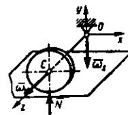
**16.3.16.** Inersiya momenti  $J_z=1,5 \text{kg}\cdot\text{m}^2$ , podshipniklар orasi  $a=0,8 \text{m}$  bo'lgan qayiqning motori o'z o'qi atrofida  $\omega_1=250 \text{rad/s}$ , suv to'lqini natijasida  $\omega_2=0,1 \text{sin}t$  burchak tezliklар bilan aylansa, podshipniklarga tushadigan giroskopik reaksiyaning eng katta qiymatini aniqlang. (46,9)
