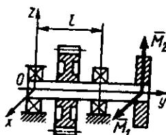
**5.2.17.** Uzunligi  $\ell=0,1\text{m}$  bo'lgan valga momentlari  $M_1=4\text{N}\cdot\text{m}$ ,  $M_2=2\text{N}\cdot\text{m}$ ,  $M_3=5\text{N}\cdot\text{m}$  ga teng juft kuchlar ta'sir etadi. Agar juft kuch momentlari vektori  $\bar{M}_1 \parallel Ox$  va  $\bar{M}_2 \parallel Oz$ ,  $\bar{M}_3 \parallel Oz$  bo'lsa,  $O$  podshipnik reaksiya kuchini hisoblang. (50)
