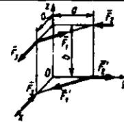
**5.2.11.** Diskning gardishiga ( $\bar{F}_1, \bar{F}_1'$ ) va ( $\bar{F}_2, \bar{F}_2'$ ) juft kuchlar ta'sir etadi. Ularning yo'nalishlari  $\bar{F}_1 \parallel Oz$ ,  $\bar{F}_2 \parallel Ox$  va qiymatlari o'zaro teng bo'lsa, teng ta'sir etuvchi juft kuchning momenti vektori  $Ox$  o'qи bilan qanday burchak tashkil etadi? (45)
