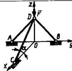
**1.4.6.** Og'ir yuklarni ko'tarish uchun ishlataladigan «uch oyoq» uchta  $AC$ ,  $OC$  va  $BC$  sterjenlar hamda dastakli barabandan iborat. Agar 1 yukning og'irligi 60N va burchaklar  $\alpha=60^\circ$ ,  $\beta=45^\circ$  bo'lsa,  $AC$  sterjen zo'riqishini aniqlang.  $DCE$  sim arqon  $Oyz$  tekisligida joylashgan. (-19,1)
