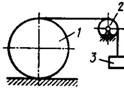
2.6.16. Radiuslari  $r=0,5\text{m}$  va  $R=1\text{m}$  bo'lgan g'altakka  $F=20\text{ N}$  li kuch ta'sir qilib, gorizontal tekislikda bir tekisda dumalaydi. Agar dumalab ishqalanish koefitsiyenti  $\delta=0,01\text{m}$  bo'lsa, g'altakning og'irligini (kN) da aniqlang. (3,0)
