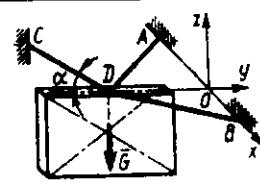
**1.4.8.** Uchta  $AO$ ,  $BO$  va  $CO$  sterjen sharnir yordamida bog'langan bo'lib,  $O$  sharniriga  $F=12N$  kuch ta'sir etadi. Agar  $AB=AO=AD$  bo'lsa,  $CO$  sterjenning zo'riqishini aniqlang. (13,9)
