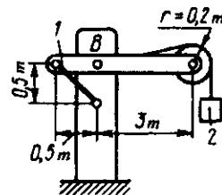
**3.2.29.** Konstruksiyaga osilgan 1 yukning og'irligi  $10 \text{ kN}$  bo'lib, 2 ustun qistirib mahkamlangan  $A$  tayanchdagi moment nolga teng bo'lishi uchun tortib turuvchi  $F$  kuchining qiymati kN da qancha bo'lishi lozim? Konstruksiyaning boshqa qismlarining og'irliglarini hisobga olmang. (21,4)
