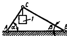
**1.2.8.** Og'irligi  $14\text{N}$  bo'lgan yuk devorga mahkamlangan.  $AC$  va  $BC$  sterjenlar hamda  $D$  barabanga o'ralgan zanjir  $C$  blok yordamida osib qo'yilgan. Agar zanjir sterjen bilan  $\alpha=30^\circ$  burchaklar hosil qilsa,  $AC$  sterjenning zo'riqishini aniqlang. (-24,2)
