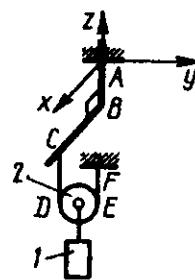
**5.7.13.** Og'irligi  $G=5\text{kN}$  bo'lgan yuk  $DE$  gorizontal sterjenga o'matilgan bo'lib, sterjen esa  $D$  nuqtasi bilan  $ABCD$  gorizontal bukilgan sterjenga tiralgan. Agar o'chamlari  $AB=BC=CD=2\text{m}$ ,  $DF=FE$  bo'lsa,  $A$  tayanchdagi momentning  $Ax$  o'qiga proyeksiyasini kN da aniqlang. (5)
