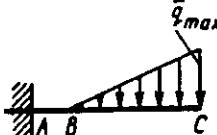
2.3.19. O'lchamlari  $AB=2\text{m}$ ,  $BC=6\text{m}$  bo'lgan to'sin devorga qistirib mahkamlangan bo'lib, unga intensivliklari  $q_{\max}=30 \text{ N/m}$  va  $q_{\min}=10 \text{ N/m}$  bo'lgan taqsimlangan kuchlar ta'sir etsa,  $A$  tayanchdagi reaktiv momentning miqdorini toping. (660)
