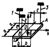
**5.5.14.** Og'irligi  $G=40$  kN, bir jinsli yarim silindr shaklidagi obolochka (yupqa qobiq)  $A$ ,  $B$  va  $C$  nuqtalaridan vertikal po'lat arqonlar yordamida mahkamlangan. Agar 3 arqonning zo'riqishi  $20$  kN bo'lsa, 1 arqondagi reaksiya kuchini kN da toping. (10)
