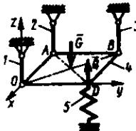
**5.5.16.** Radiuslari  $r=0,1$ m va  $R=0,14$ m, og'irligi  $G=6$  kN bo'lgan val 1,2 va 3 vertikal po'lat arqonlar yordamida gorizontall holatda ushlab turiladi. Agar 2 va 3 arqonlardagi taranglik kuchlari  $T_2=T_3=1,75$ kN bo'lsa, 1 arqonning taranglik kuchini hisoblang. ( $2,5 \cdot 10^3$ )
