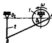
**9.6.21.** Mexanizm uzunligi  $AB=30\text{sm}$  li krivoship vositasida bog'langan ikkita g'ildiraklardan hamda 3 shatuniga o'matilgan  $C$  polzundan iborat. Agar g'ildiraklarning radiusi  $r_1=r_2=15\text{sm}$ ,  $C$  polzunning tezligi  $0,3\text{m/s}$  bo'lsa, 1 g'ildirakning burchak tezligini  $\varphi=90^\circ$  holat uchun aniqlang. (2)
