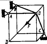
**1.4.9.** Uchta  $AO$ ,  $BO$  va  $CO$  sterjen sharnir vositasida bog'langan bo'lib,  $O$  sharniriga  $F=18N$  kuch ta'sir etadi. Agar burchaklar  $\alpha=30^\circ$  va  $\beta=45^\circ$  bo'lsa,  $AO$  sterjendagi zo'riqishni toping. (-25,5)
