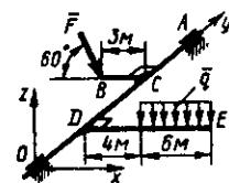
**5.6.4.**  $AOB$  valga to'g'ri burchak ostida  $BC$  va  $DE$  sterjenlar mahkamlangan bo'lib,  $BC$  ga  $\alpha=30^\circ$  burchak ostida  $\bar{F}$  kuchi va  $DE$  ga intensivligi  $q=0,5\text{N/m}$  bo'lgan taqsimlangan kuch ta'sir etadi. Agar  $\bar{F} \parallel Oxz$  bo'lsa, val yuqoridagi kuchlar ta'sirida muvozanatda bo'lishi uchun  $\bar{F}$  kuchining qiymatini toping. (6,75)
