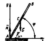
**16.2.8.** Massasi  $m=700\text{kg}$  bo'lgan 3 qurvurni yuqoriga ko'tarish uchun 1 va 2 vertikal arqonlardan foydalанилди. Agar arqonlardagi taranglik kuchlari mos ravishda  $T_1=3504\text{N}$  va  $T_2=4133\text{N}$  bo'lsa, quvur massa markazi  $C$  ning tezlanishini aniqlang. (1,1)
