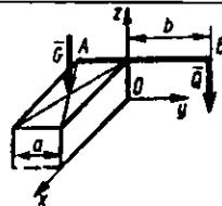
**5.5.6.** O'lchamlari  $a=0,5\text{m}$ ,  $b=1\text{m}$ ,  $c=1,5\text{m}$ , og'irligi  $G_1=500\text{ N}$  bo'lgan uch oyoqli platformaning ustida vazni  $G_2=50\text{ N}$  yuk muvozanatda turadi. Agar  $\bar{G}_1$ ,  $\bar{G}_2$  kuchlar va  $A$  tayanch nuqtasi bir vertikal tekislikda joylashgan bo'lsa,  $A$  tayanch reaksiya kuchini aniqlang. Bunda  $AB=BC=AC$ . (200)
