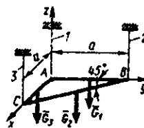
**5.5.12.** O'lchamlari  $a=0,4\text{m}$  va  $EF=AD$  bo'lgan, og'irliklari  $G_1=10\text{N}$  va  $G_2=8\text{N}$  li ikki plastinalar sharnirlar yordamida bir-biriga hamda sterjenlar vositasida tayanchlarga mahkamlangan. Agar  $ABCD$  gorizonttal tekislikda,  $ADEF$  vertikal tekislikda joylashgan bo'lsa, 1 sterjendagi reaksiya kuchini toping. (-4)
