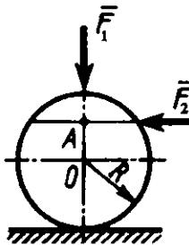
**2.6.4.** Og'irligi  $2 \text{ kN}$  bir jinsli g'ildirakka gorizontal  $\bar{F}$  kuchi ta'sir etib, g'ildirak sirpanmay va dumalamay turishi uchun kuchning eng katta qiymatini toping. Bunda g'ildirakning radiusi  $R=0,6\text{m}$  va o'lchamlari  $OA=0,4\text{m}$ . Sirpanib va dumalab ishqalanish koeffitsiyentlari  $f=0,2$  va  $\delta=0,006 \text{ m}$  deb oling. (12,0)
