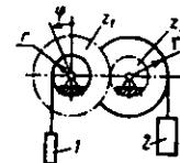
**20.2.12.** Radiuslari  $R_1=0,3\text{m}$ ,  $R_3=0,5\text{m}$  bo'lgan uchta g'ildirak friksion uzatmani hosil qilib, ularga momentlari  $M_1=15\text{N}\cdot\text{m}$  va  $M_3=5\text{N}\cdot\text{m}$  li juft kuchlar ta'sir etadi. Umumlashgan koordinata sifatida 1 g'ildirakning burlish burchagi  $\varphi_1$  ni olib, unga mos umumlashgan kuchni aniqlang. (12)
