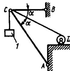
**1.2.9.** Og'irligi  $20\text{N}$  bo'lgan yuk shifsga mahkamlangan  $OA$  va  $OB$  sterjenlarga hamda  $C$  nuqtaga bog'langan arqon yordamida osib qo'yilgan. Agar  $\alpha=40^\circ$  va  $\beta=45^\circ$  bo'lsa,  $OA$  sterjenda hosil bo'lgan reaksiya kuchini toping. (-21,7)
