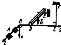
5.7.4. Og'irligi  $G=800 \text{ N}$  li yuk gorizontal DE to'singa o'rnatilgan. DE to'sin esa gorizontal joylashgan vertikal FH sim arqon yordamida osib qo'yilgan ABCD konstruksiyaga erkin tiralgan. Agar masofalar  $DF=2FB$  va  $AB=BC$  bo'lsa, A podshipnikning reaksiya kuchini aniqlang. (400)
