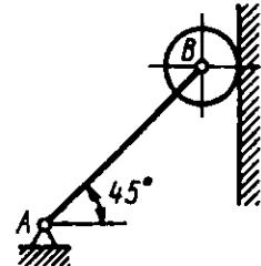
**3.2.28.** Konstruksiya 1 sterjen, 2 yuk va boshqa qismlardan iborat bo'lib, uning 2 qismi  $100\text{N}$  ga teng. Boshqa qismlarning vaznlarini hisobga olmay, 1 sterjenda hosil bo'layotgan zo'riqish kuchini hisoblang. (905)
