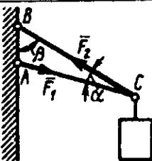
**1.2.5.** Og'ir yuk  $AC$  va  $BC$  vaznsiz sterjenlar yordamida devorga mahkamlangan. Agar  $AC$  sterjen devor bilan  $\alpha=60^\circ$ , sterjenlar o'zaro  $\beta=45^\circ$  burchak tashkil qilgan bo'lib,  $AC$  sterjenning siqilishi  $F_2=25\text{N}$  bo'lsa,  $BC$  sterjendagi zo'riqishni hisoblang. (48,3)
