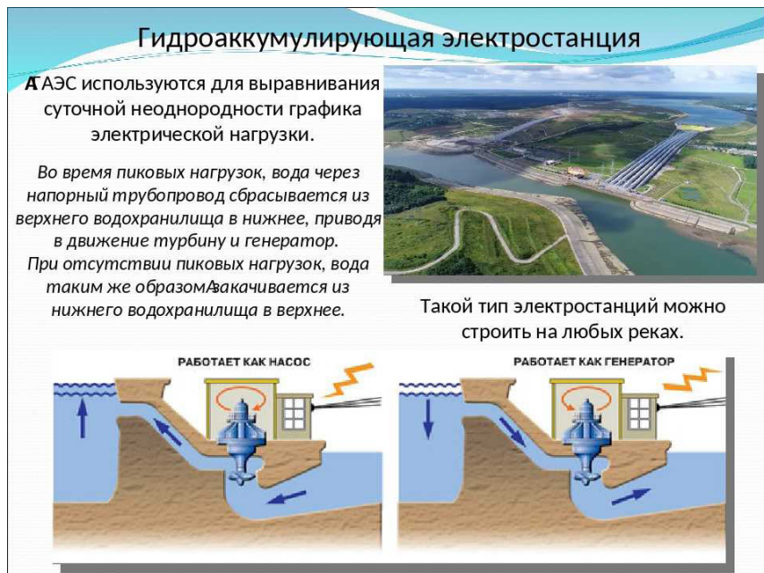
Рис.1. Схема гидроаккумулирующей станции
