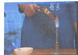
Qo'rg'oshin (II) nitrat kristallari qizdirilganda parchalanadi
