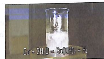
Kalsiy metallining suv bilan reaksiyasi
