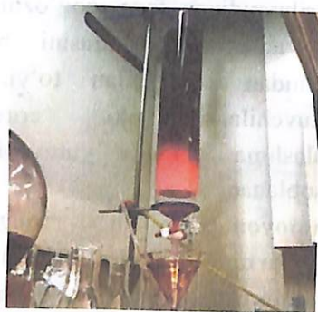
Kolonkali xromatografiya (A,B,C moddalar)
