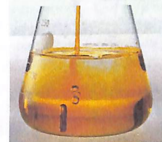
Sovun kungaboqar yog'i va suvning emulsiyasini barqarorlashi
