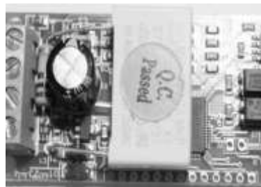
9-расм. 256 байтли Atmel 24C02C EEPROM чипи ва кетма-кет интерфейсининг галваник изоляциясини таъминлайдиган иккита PC817 оптапара.
