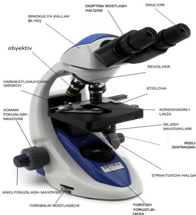
1-rasm. OPTIKA ITALY B-191 rusumli binokulyar mikroskop tuzilishi
