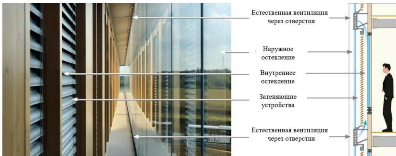
Рис. 8. Конструкция двойного стеклянного фасада [42]
