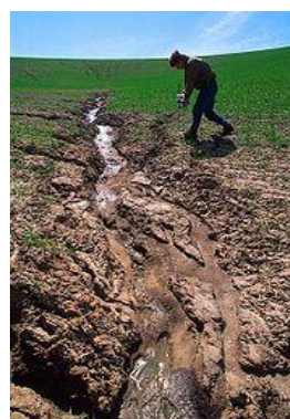
3-рasm. Сув оқими ҳосил қилган ўйиқлар усулида ювилиш миқдорини аниқлаш
