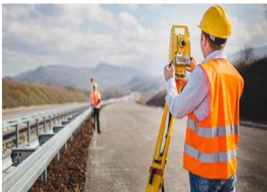
4-расм. Leука-электрон тахеометри ёрдамида съёмка қилиш.
