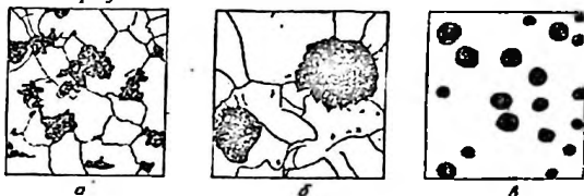
8.6-rasm. Bolg'alanuvchan va mustahkamligi govori cho'yanlarning mikrostrukturalari: a-asosi ferritli bog'lanuvchan cho'yan; b-asosi ferritli mustahkamligi yuqoricho'yan; v - kislota eritma ta'siriga berilmagan mustahkamligi yuqori cho'yan.
